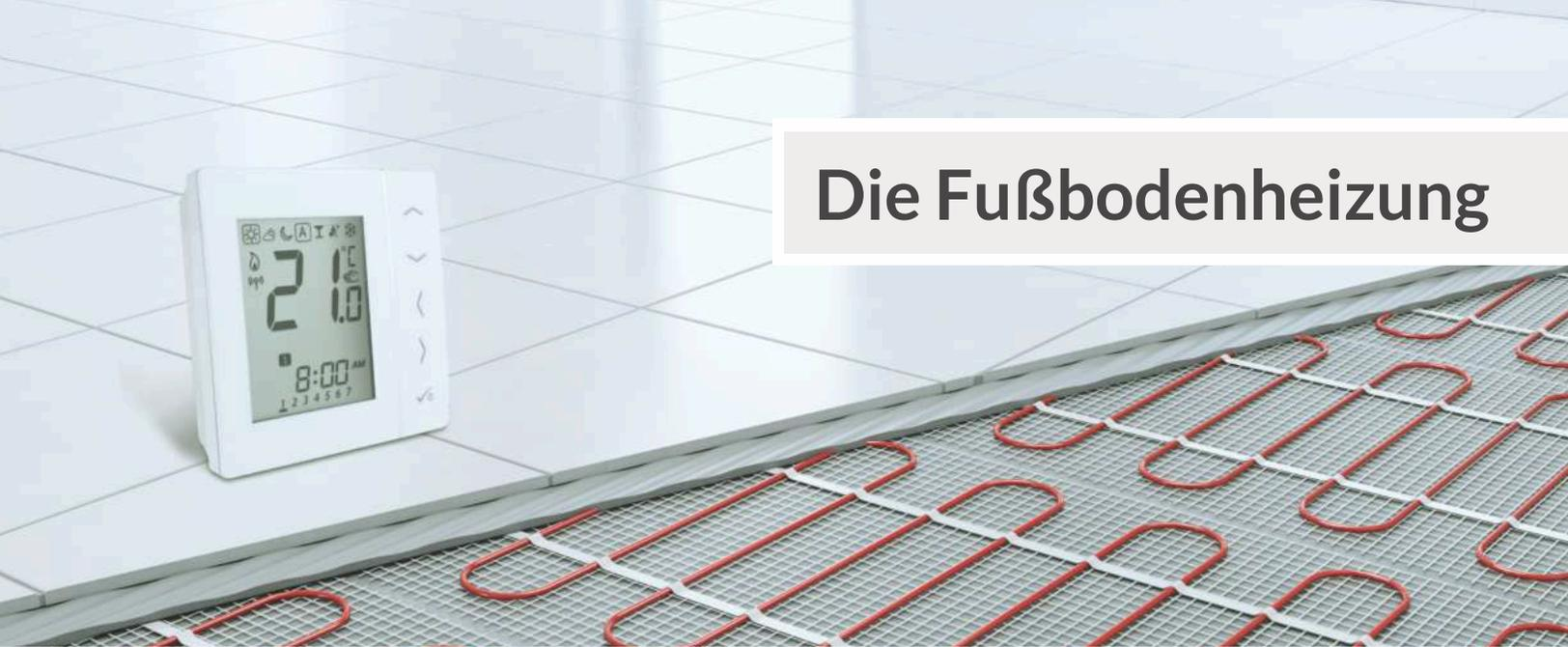
Die Fußbodendirektheizungen ist eine Niedrigtemperatur-Flächenheizung und wird direkt zwischen dem Estrich und dem Fußbodenaufbau verlegt. Eine optimale Alternative für den Neubau als auch für die Modernisierung. Anzuwenden für alle Fußbodenheizung geeignete Fußbodenbeläge.
